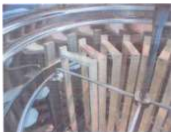
1.-es ábra Keret elhelyezése tangenciális mézpergetőbe
