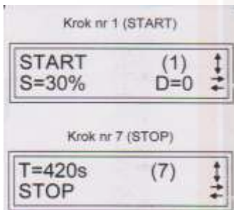
4-es ábra A technológiai ciklus programozása – (1) és (7) lépés
