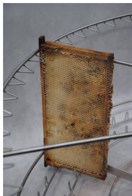
Obr.8 Príklad na uloženie rámmika do radiálneho kôša (vľavo) a kazetového kôša (vpravo)
