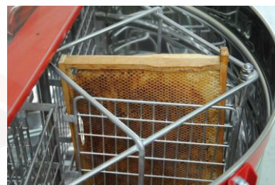
Obr.8 Príklad na uloženie rámmika do radiálneho kôša (vľavo) a kazetového kôša (vpravo)
