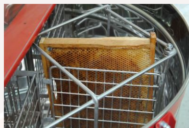
Obr. 2 – správne uloženie rámkov v kazetovom medomete
