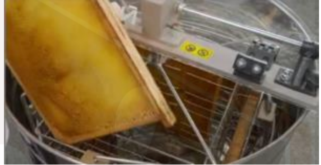
Obr. 1: správne uloženie rámkov v ručne zvratnom medomete
