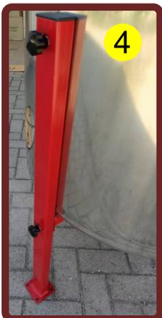
podotáhujeme rýchlopínacie matice na nožičkách, primontujeme rúčku. Nakoniec ovinieme tesniacu pásku na závit ventilu a nakrútime výpustný ventil. Založíme na vrch krycie plechy s úchytmi
