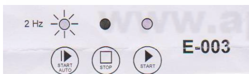
Obr. 5 Chyba – zaseknuté alebo blokové tlačidlo štartu pre nepretržitú prevádzku
