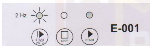
Obr. 3 Chyba – zaseknuté alebo blokové tlačidlo štartu pastovacieho cyklu
