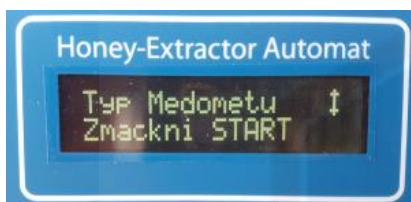
Obr.7 Menu ovládania - Nastavenie typu medometu
