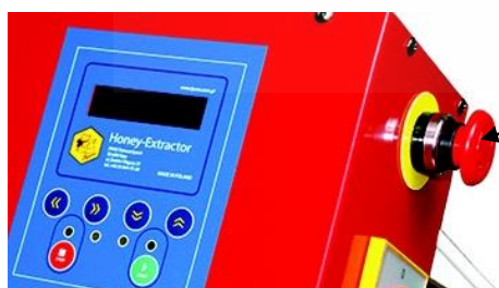
Obr.8 Bezpečnostný spínač STOP („NÚDZOVÉ ZASTAVENIE“)
